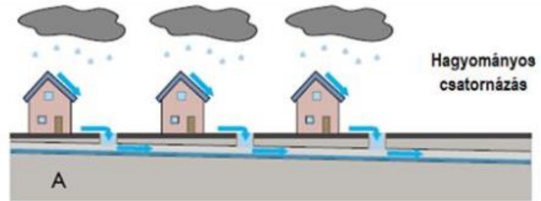
Hagyományos, elvezetés orientált csapadékcatornázási gyakorlat
