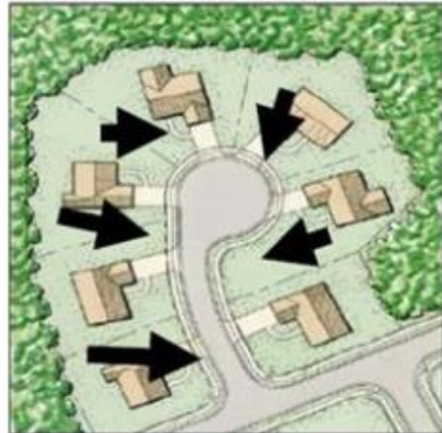
Hagyományos, elvezetés orientált csapadékcatornázási gyakorlat
